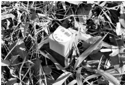
ブラ杭にナンバープレートを打設した境界杭
