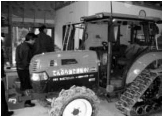
▲廃食用油を精製して作ったバイオディーゼル燃料で動くトラクター
