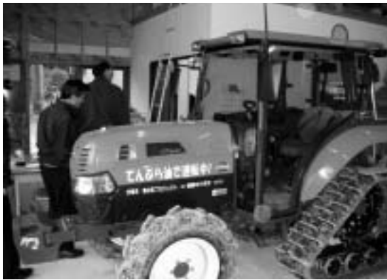
▲廃食用油を精製して作ったバイオディーゼル燃料で動くトラクター
